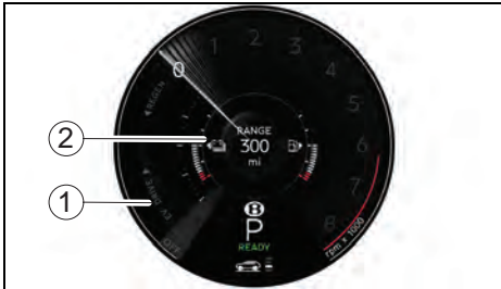
仪表板上的「EV DRIVE」(1) 和高电压电池电量计 (2)
