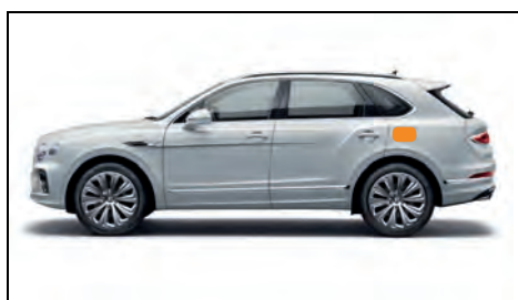
車両の左手裏にある充電ソケットのフタの裏の車両充電接続部
