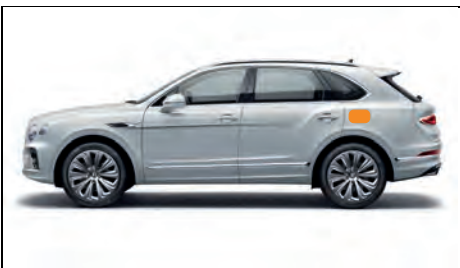
Fahrzeuginnenanschluss hinter der Abdeckung der Ladebuchse links hinten im Fahrzeug
