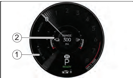
„EV DRIVE“ – „EV-Antrieb“ (1) und Hochvoltbatterie-Anzeige (2) im Kombi-Instrument
