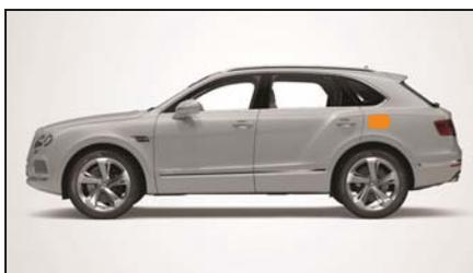
Fahrzeug-Ladeanschluss hinter der Abdeckung der Ladesteckdose hinten links am Fahrzeug
