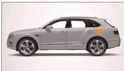
車両後部左側充電ソケット リッドの後ろの車両充電接続部
