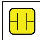
Supercondensador, baja tensión
