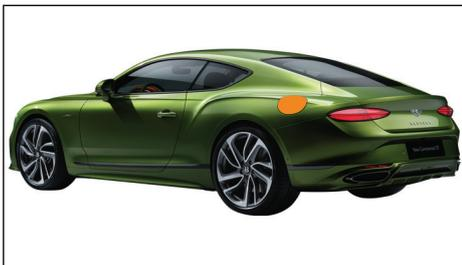
Conexión de carga del vehículo detrás de la tapa de la toma de carga en la parte trasera izquierda del vehículo.
