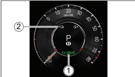
"EV DRIVE" (1) e indicador de batería de alta tensión (2) en el grupo de instrumentos.
