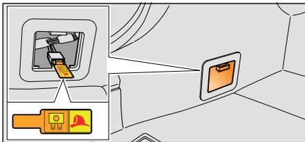
1. Abra la cubierta de la caja de fusibles en el lado izquierdo del maletero.
