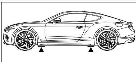
Si es necesario, levante el vehículo en los puntos de elevación marcados.
