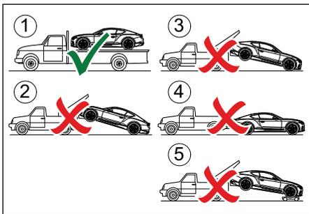
Después de un accidente, si no es posible conducir el vehículo normalmente, el vehículo debe ser remolcado.
