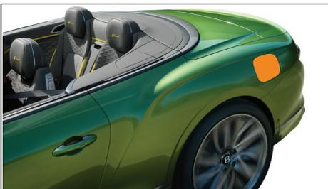
车辆左后方充电插座盖后面有车辆充电接口。
