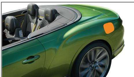
Connexion de charge du véhicule derrière le couvercle de la prise de charge à l'arrière gauche du véhicule.
